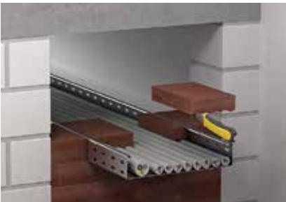
Монтаж осуществляется при помощи канцелярского ножа. Кирпичи укладываются в проходку без использования дополнительных клеев, мастик и т. д.
