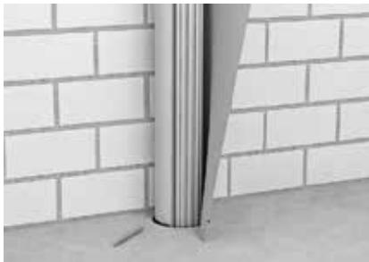
Установка огнестойкого бандаж.
