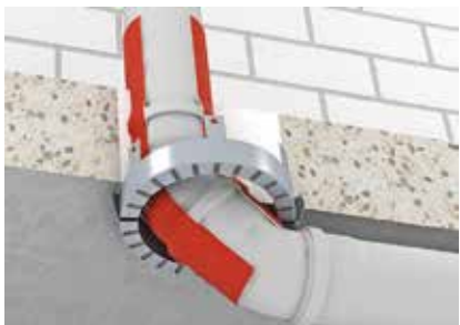
Муфты для труб в месте прокладки.
