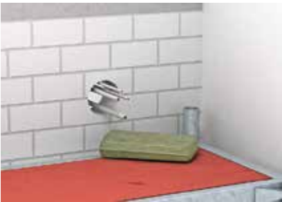
Минеральная вата с точкой плавления \geq 1000\text{ }^{\circ}\text{C} для заполнения отверстия.
