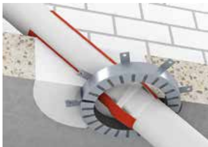
Прокладка трубы под углом не более 39°.
